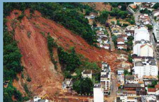
写真9 表層崩壊による災害発生状況(リオデジャネイロ) (出典: Schaffer W. B., et al. 2011)
