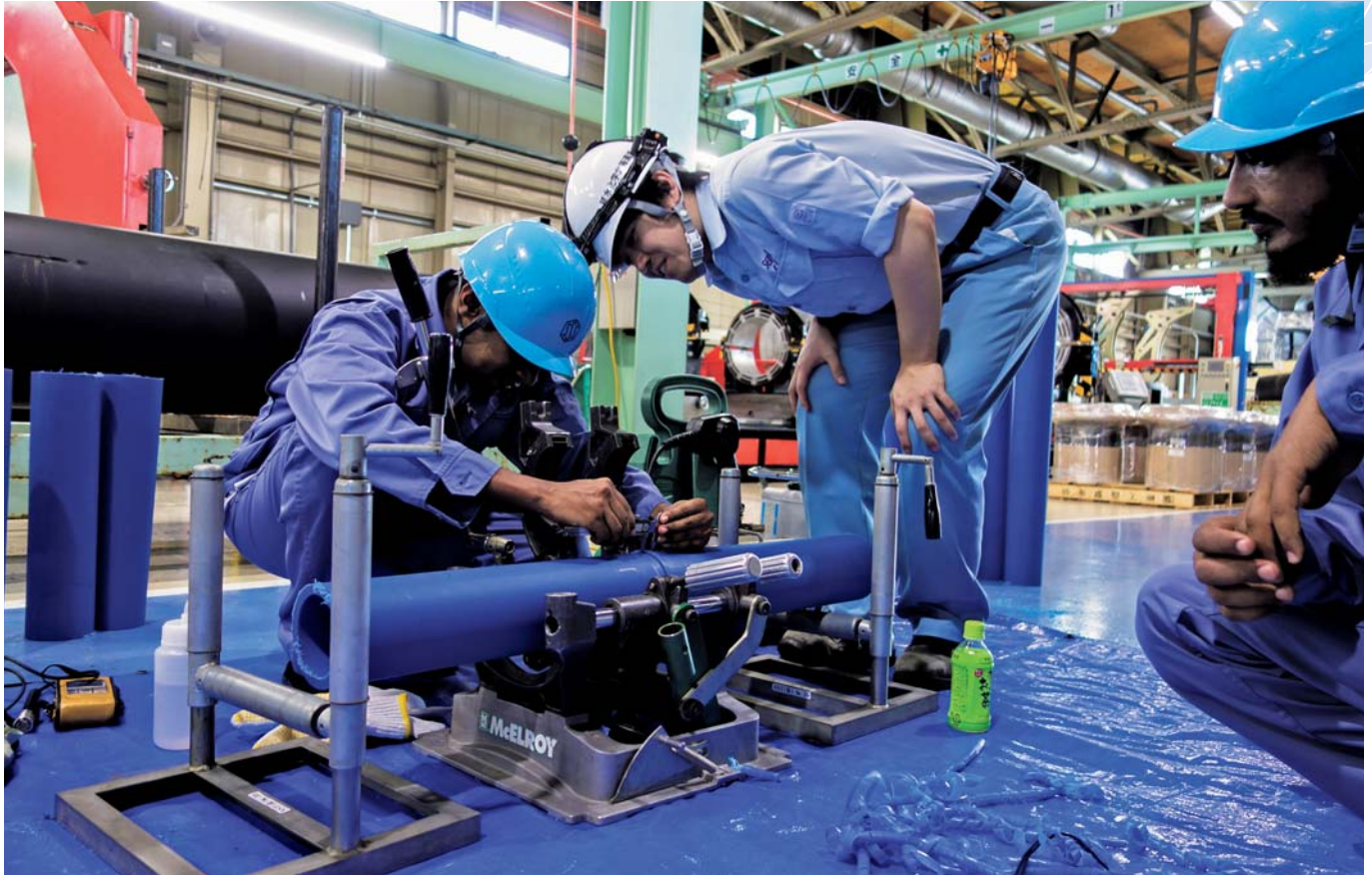
積水化学北海道株式会社で水道管接合を経験する研修員（札幌市）
