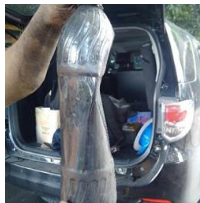
【図2】無煙炭試料の酸素吸収によるペットボトルの変形
