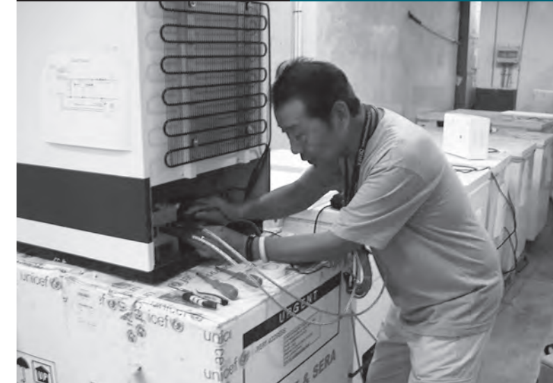
冷凍庫の修理を行う今井さん。スイッチ、温度調節器、温度表示器など電気系統を中心に不具合発生部品を探し出す
