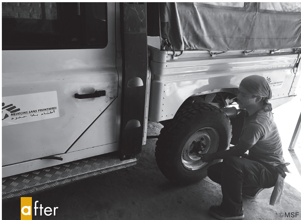
国境なき医師団で派遣されたスーダンにて、地方プロジェクトで整備した車両の完成検査を行う川内さん。車両整備の業務以外に、運行記録や、車両のメンテナンススケジュールの管理、部品管理、ボートがある場合はその整備も行う。医療スタッフの活動先は電気がない場所や停電する場所が多いため、活動先に発電機が設置されており、その整備・点検も川内さんの仕事だ
