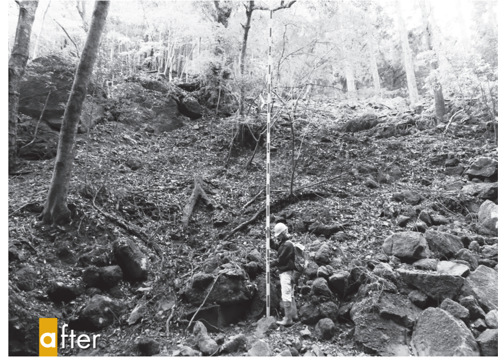
渓流にダム建設を計画するための測量補助作業中の堀切さん。堀切さんの会社が実施する業務の一例は次の通り。豪雨などで山間部の渓流が荒廃した場合、その渓流を安定させるためのダムを設計する業務が、省庁から公示される。その業務に関する提案書を省庁に提出し、入札。落札後、現地調査や測量を行い、発注者と相談しながら計画する位置やダムの種類を決め、対象地の現況や設計図面、計画案等をまとめた報告書をつくり、それを省庁に提出して終了となる
