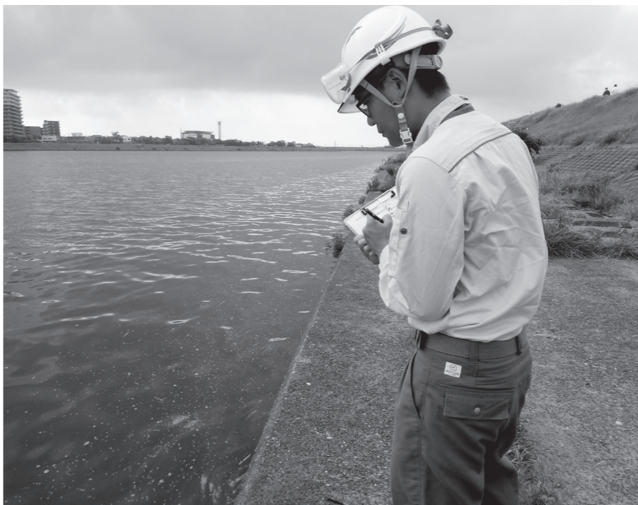
河川の水質をチェックする現在の宮さん。水の量や濁りなどを確認し、水処理を行う際の薬品の量や、水処理をする水量などを決める目安のひとつにする。たとえば、台風が来ると水が濁り、使う薬品の量が変わる
