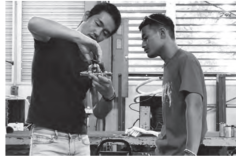
冷凍機器取り扱いの必須アイテム「フレアツール」の使い方を生徒に指導する前田さん(左)
