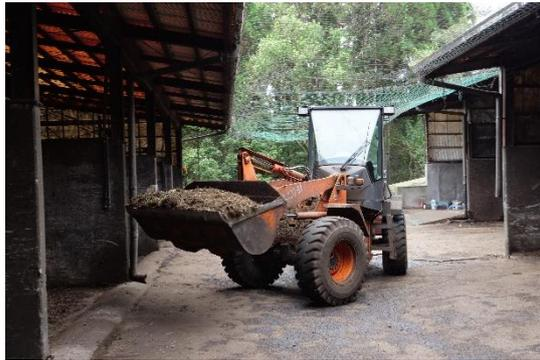
写真 6-32 機材による堆肥の攪拌
