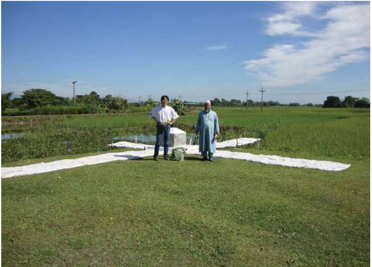
航空写真上で位置を計測する標識(砂を詰めた白い砂袋)の前で (写真: 浦部ぼくろう)
