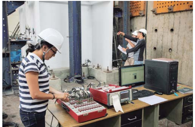
Personal midiendo el daño de una pared a causa de un terremoto (Fotografía: Kosuke Okahara/JICA)
