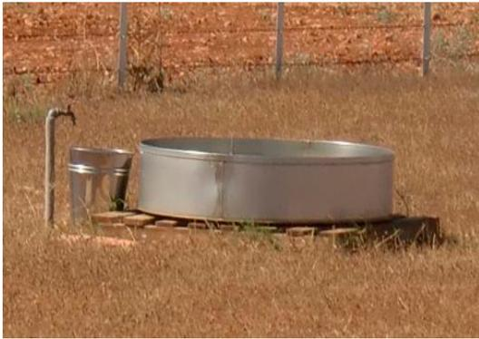
**Fotografía 1.** Evaporímetro de Tanque Clase-A.
