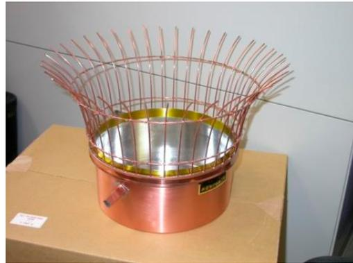
**Fotografía 2.** Evaporímetro de tanque.
