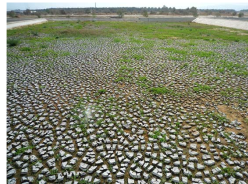
天日干しされた脱 水汚泥。堆肥利 用が検討されて いる。
