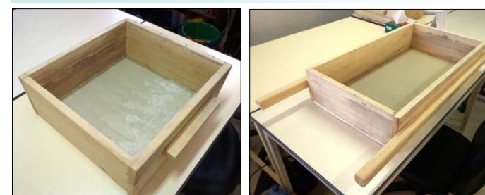
写真5（左から）：①製作した試作品、45(W)×45(L)×15(H)cm、②2人で使用可能とした試作品。
