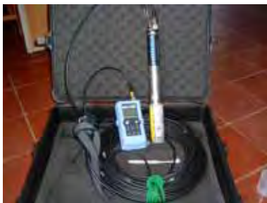
Termo-salinómetro eléctrico HORIBA W-22XD
