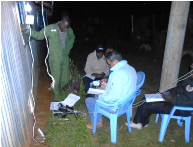
夜間最小流量の計測とステップテストの実施
