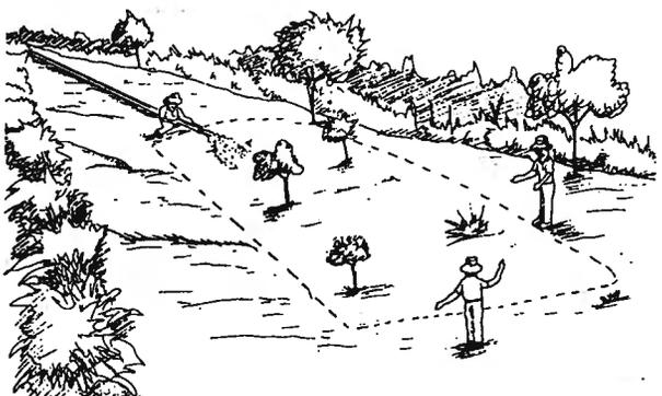
Una vez escogida el área se procede al marcado del terreno y se empieza la apertura del estanque, cuya dimensión depende de la disponibilidad de terreno y la profundidad será de 1 m máxime, con una entrada y salida de agua.
