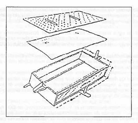
Una de las paredes laterales es de plástico transparente (o vidrio resistente). En la parte frontal superior tiene una especie de vertedero tipo V que a diferencia de la caja de erosión no está conectada a un orificio de salida. Internamente la caja tiene un "doble fondo" con las siguientes características:
