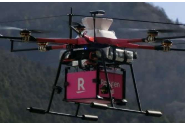
農作物を運ぶ物流用ドローン。「ルワンダ国 次世代型モビリティ(ドローン)を活用した 高付加価値農作物輸出促進のための普及・実証・ビジネス化事業」にて活用を検証。
