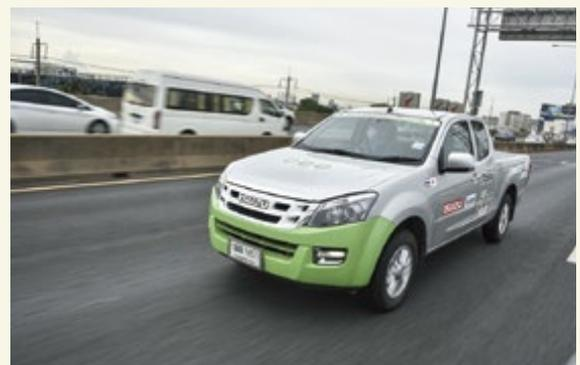
H-FAME混合燃料の実車試験
