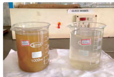
ナガサンドラ下水処理施設の汚水(左:処理前、右:処理後)
