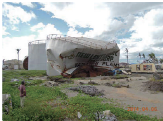
台風で横転したココナッツオイルタンク。台風の威力のすさまじさが分かる
