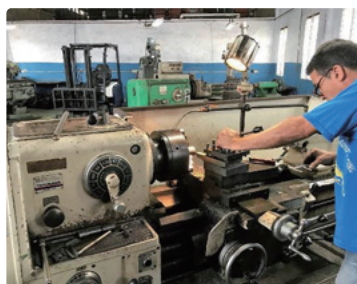
供与機材による部品の加工(車両修理工場)
