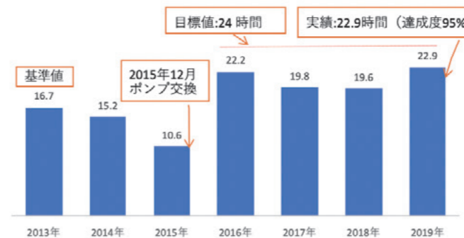
図1 ニュウファナッピン第一期浄水場ポンプの日平均運転時間(単位:時間/日/台) 出所:事後評価時の水資源・上水オーソリティへの質問票回答より評価者作成
