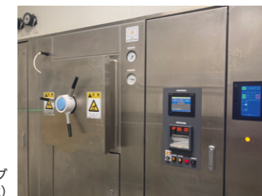
オートクレーブ（滅菌処理の機械）
