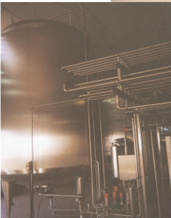
本事業にて購入・設置された市乳処理 プラント（高温殺菌を行っている）
