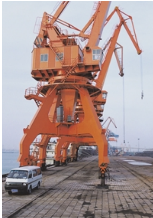
設置されたポータブルクレーン
