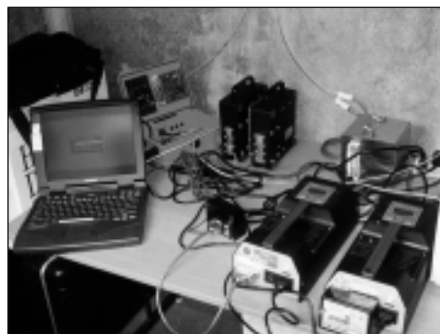
図-1: 大気中硫化水素濃度測定装置
