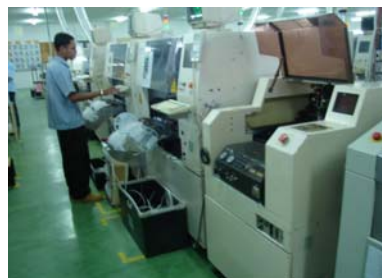
図-8 本事業サブローンにて購入した電子回路基盤製造設備
