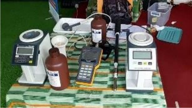
ケツトのカシューナッツ専用水分計 HB-600(写真中央)とカシューナッツ測定にも対応した穀類水分計 PM-650(同左端)と PM-450(同右端)
