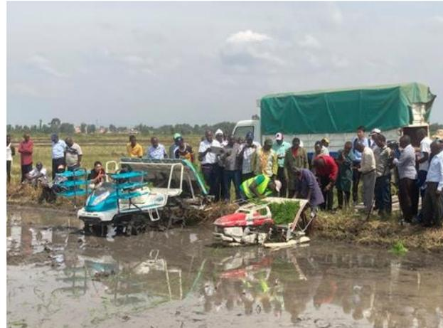
クボタ製6条乗用型田植機(左)と三菱製4条歩行型田植機の圃場でのデモの様子
