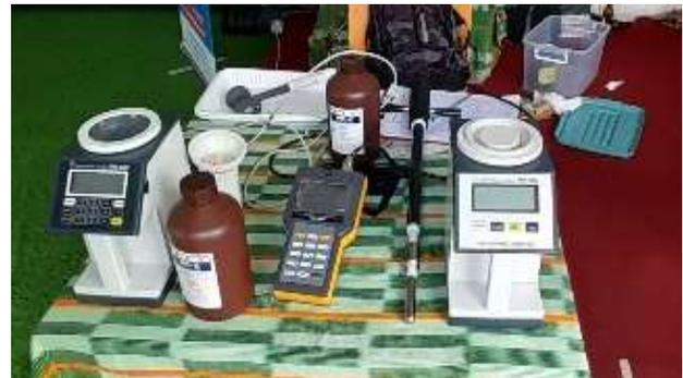
Testeurs d'humidité Kett, PM-650 (à gauche), HB-600 (au centre) et PM-450 (à droite).
