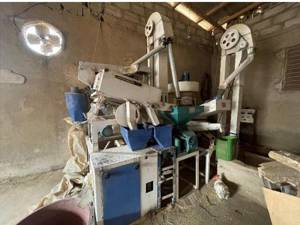
現地の精米所で多く見られる中国製の粉摺り精米機。
