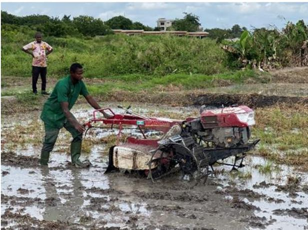
PRORIL2 に導入されたヤンマー製耕うん機 YZC-D。ヤンマー製は前後バランスが良く操作しやすいと好評。
