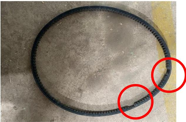
破損したコンバインハーベスター用ベルト(赤丸)
