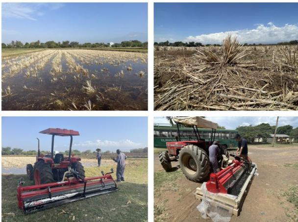
稲株が大きかったこともあり、2~3回同じところを代掻き、土寄せして2時間ほどで作業を終了しました。見学をしていたKATC職員達からは作業スピードが早く、仕上がりが綺麗だと喜びの声があがりました。特にオペレーターから好評だったのは、リアカバーを固定して行う「土引きモード」による土の移動でした。使いこなすにはある程度の操作技術が必要になりますが、土を移動させ易く、水田の均平化を効率良く行うことができます。
