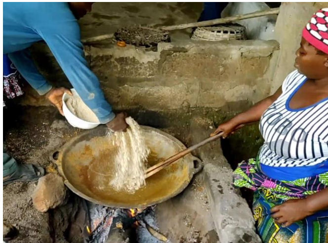
Ajout du liant dans l'eau bouillante
