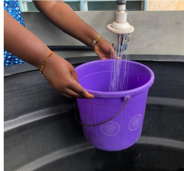
Mesure du volume d'eau à l'aide d'un seau gradué
