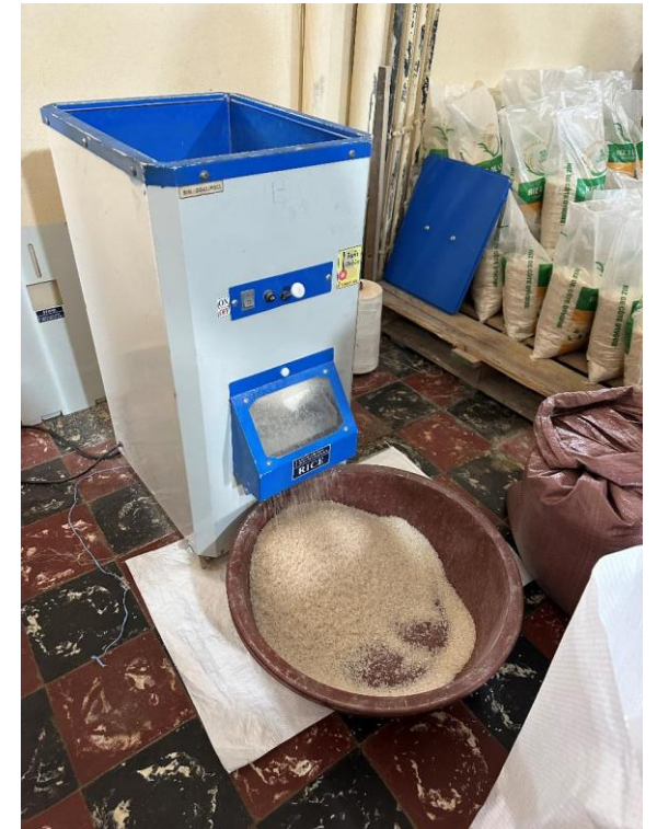
稼働中のカンリウ工業の石抜き機
