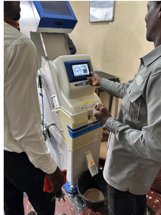
稼働中のサタケの光選別機
