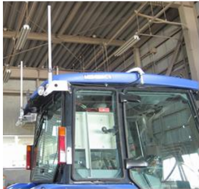
通信用アンテナ
