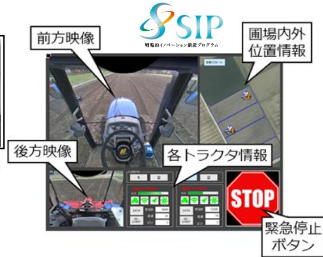
監視用全周囲カメラ
