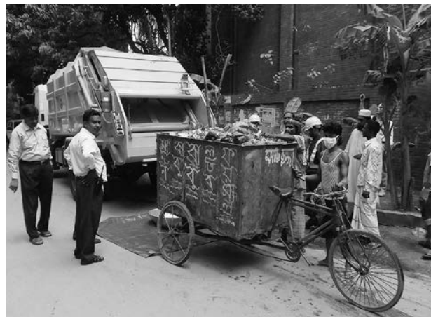
写真-1 リキシャパン(一次収集)からコンパクト(二次収集)へのごみの移し替え:ダッカ市(当時)
