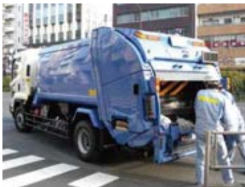
写真 4-5 パッカー車による収集作業の様子
