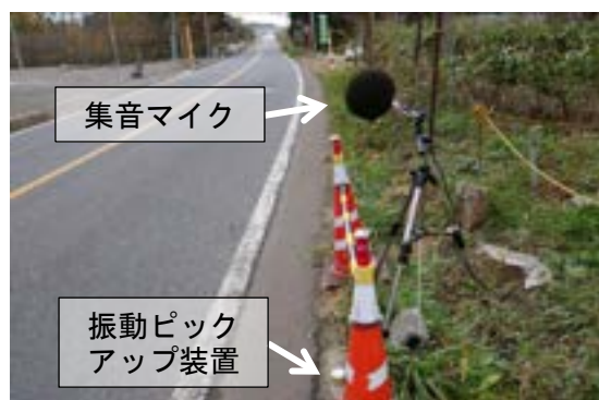
写真 1-11 沿道での騒音振動調査
