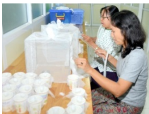
Bioassay: 殺虫剤処理蚊帳の効力判定試験
