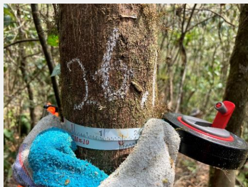
直径巻き尺で胸高直径を測る
