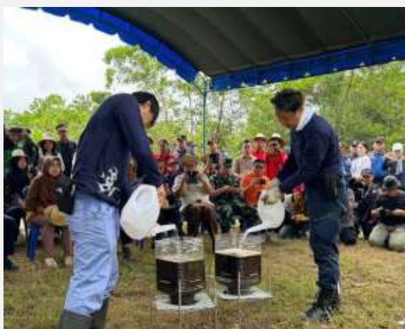
実証実験 消火剤の地中浸透性を実証
