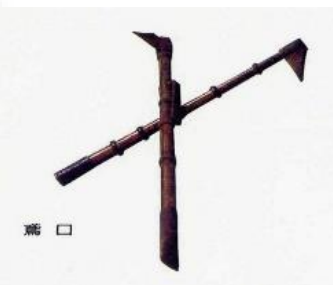
鳶口（とびぐち） 延焼を防ぐために家屋を壊す道具
