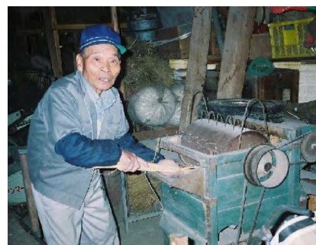
(上)「都カマド」の制作者二宮久雄さんが昭和20年代に作成した「二宮式脱穀機」(2002年撮影) 出典:生活改善ツールキット、JICA農村開発部2006年
