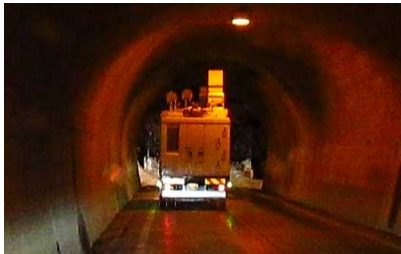
Aトンネル(画像、レーザ、レーダ3種)
