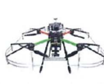
マルチコプターによる 近接撮影と異状箇所の 2次元計測
