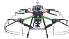
マルチコプターによる 近接撮影と異常箇所の2次元計測 夢想科学
