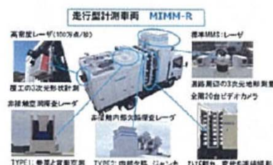
走行型高速3Dトンネル点検システム MIMM-R（ミー・アール）
