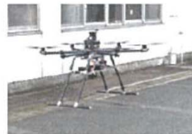
非GPS環境対応型マルチコプターを用いた 近接目視点検支援技術 三信建材工業
