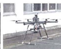
非GPS環境対応型 マルチコプターを用いた 近接目視点検支援技術
