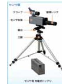
反射ターゲット貼付により桁下から非接触にて精度良く測定が可能
