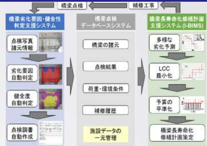
橋梁長寿命化修繕計画策定支援システム 概念図(日本海コンサルタント)
