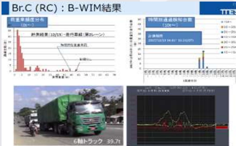
橋梁たわみによる車両重量計測サービス (BWIM), TTES
