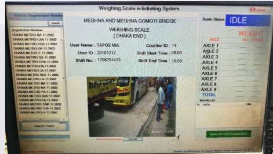
有料道路料金所での軸重計測のデータ表示画面
