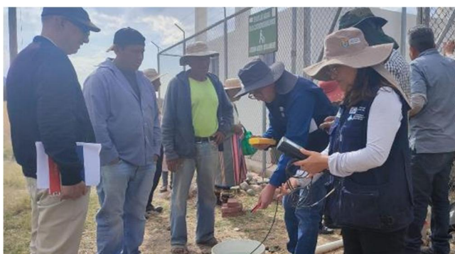
写真 1：パイロットエリアにて、大学と GIAC2 共同での灌漑用井戸の水位と水質の測定作業の様子。
