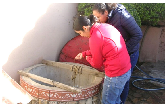
Fotografía 3: Observación continua del nivel de aguas subterráneas no confinadas para utilizar como datos de calibración del modelo de tanque
